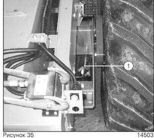
Гидравлический цилиндр, выравнивание машины с левой стороны (2)
